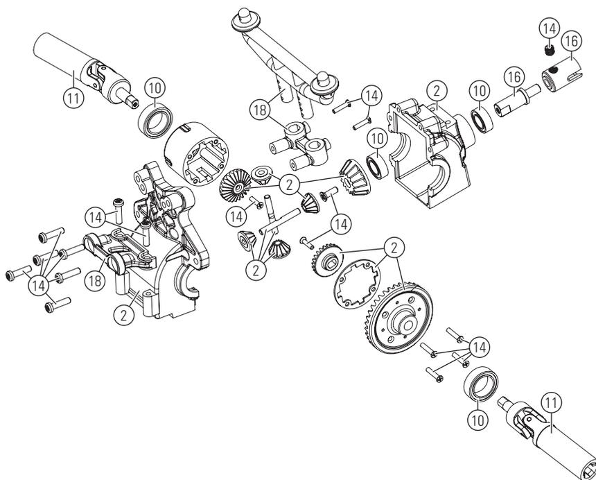
**PARTS DIAGRAM | EXPLOSIONSZEICHNUNG | VUE ÉCLATÉE DES PIÈCES |
